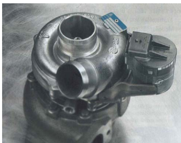
→写真9：可変ターボチャージャ を備えたトルク・モーター（乗用車用）
